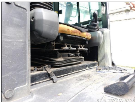
ภาพที่ 56 ใช้วัสดุป้องกันความสั่นสะเทือนรอง ไว้ใต้เครื่องจักร
