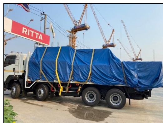
ภาพที่ 10 ใช้ผ้าใบปิดคลุมท้ายกระบะบรรทุก
